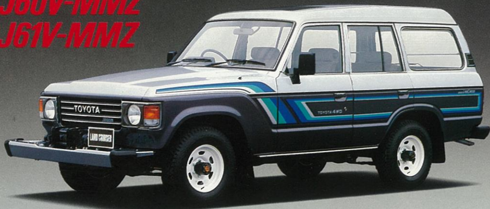
写真はHJ60V-PMZ(W)メカニカルウインチ装着車 ワイルドステージ・トーンリングのボデーカラー、サイドストライブはオプション、フルフロートリアアクスル&L.S.D.はセットオプション。
