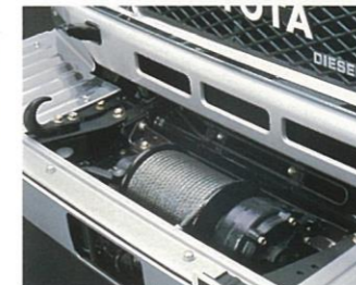
メカニカルウインチ 70系機タイプにオプション、 その他の車種には装着車設定
