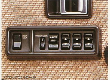
写真③HJ60V-PMZ、パワーウィンドウは全ドアロックコントロールとセットオプション。
